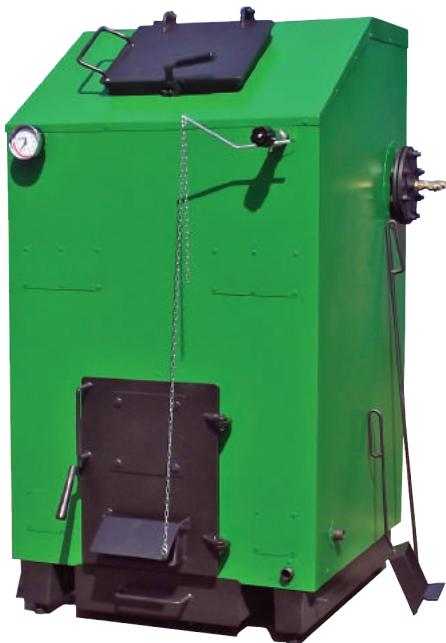
Univerzalni trajno žareći kotlovi predviđeni su za rad na tvrdom gorivu (ugalj, drva, drveni opiljci, pelet...), tako i sa gasom, lož uljem i elektro grejačima. Pri korišćenju uglja vreme rada sa jednim punjenjem kotla OGANj-3 (cca 40kg) omogućava grejanje od 18 do 24 časa.
